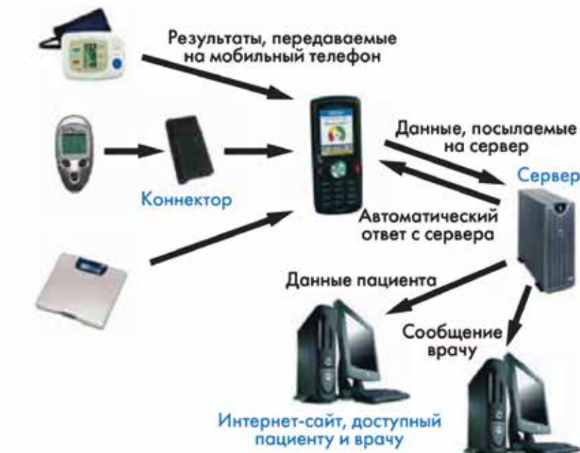
Рисунок 2. Схематичное изображение принципа работы модели Confidant system [43]
