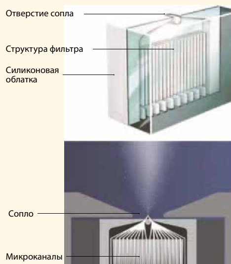
Рисунок 2. Схема устройства униблока в ингаляторе Респимат
